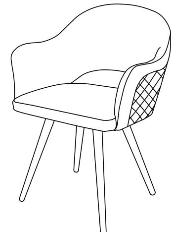
После сборки изделия допускается отклонение от плоскости 4 ножек до 1,5 мм, которое нивелируется в процессе эксплуатации
