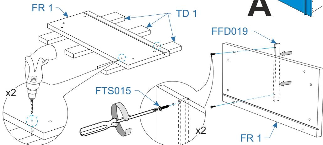
! Во избежание сколов подложить технические детали TD 1 под отверстия фасада, просверлить сверлом 5 мм.
