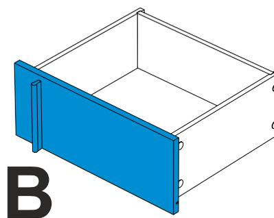
8. ! Во избежание сколов подложить технические детали TD 1 под отверстия фасада, просверлить сверлом 5 мм.
