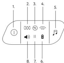
1. Кнопка включения устройства
