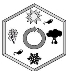
СЛЕДУЕТ ПРОИЗВОДИТЬ СМАЗКУ ТРУЩИХСЯ ЭЛЕМЕНТОВ МЕХАНИЗМА НЕ РЕЖЕ, ЧЕМ 2 РАЗА В ГОД
