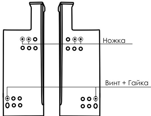
Установка ножек производится в любое из двух указанных отверстий
